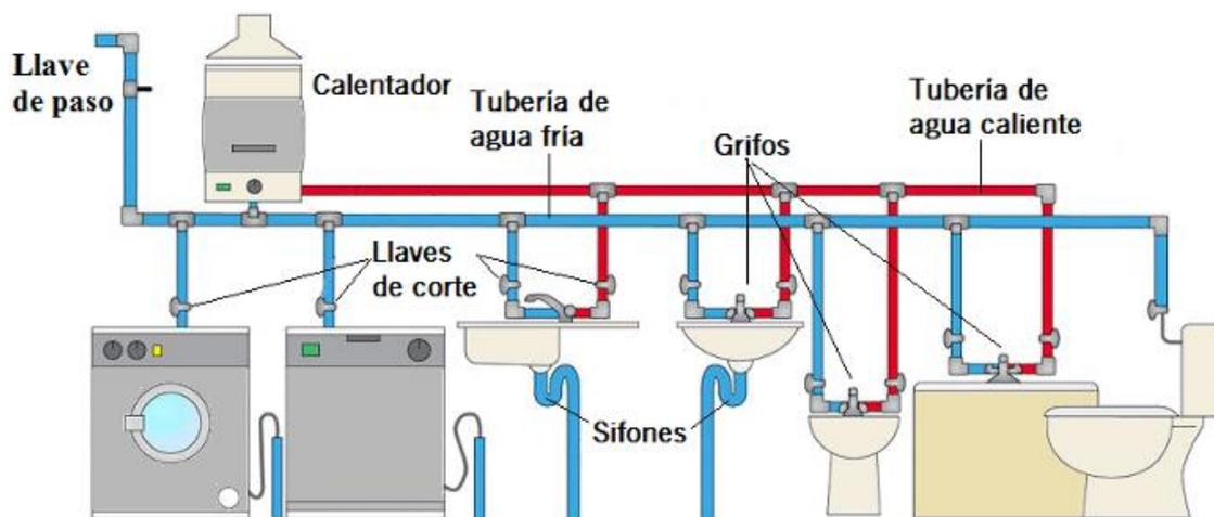
La instalación de agua está formada por **dos circuitos paralelos**: el de agua fría y el de agua caliente. Para calentar el agua se usa un **calentador**. Encontramos calentadores eléctricos, de gas propano o butano o colectores solares.
