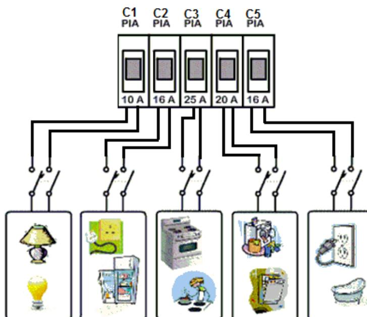
En este grado de electrificación básico se instalarán los siguientes circuitos independientes:  $C_1$ , para los puntos de iluminación;  $C_2$ , para las tomas de corriente de uso general y frigorífico;  $C_3$ , para la cocina y horno;  $C_4$ , para la lavadora, lavavajillas y termo eléctrico y  $C_5$ , para las tomas de corriente de los cuartos de baño, así como las bases auxiliares del cuarto de cocina.
